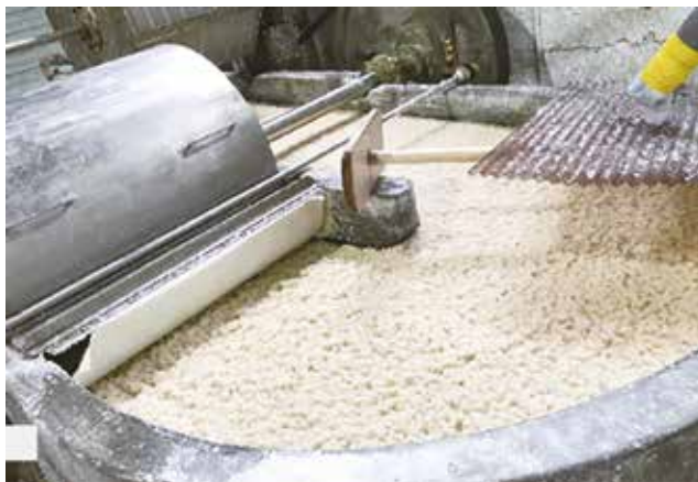
写真2 ビーター（叩解機）で①を水と混ぜ合わせる 出典：一般社団法人サーキュラーコットンファクトリー。
